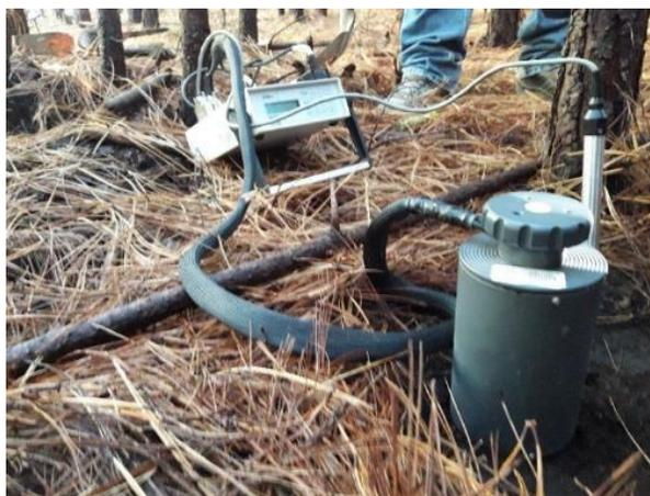
Fig. 2. Estimación del flujo de CO<sub>2</sub> mediante el sistema portátil EGM-4
