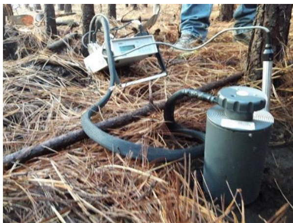
Fig. 2. Estimación del flujo de CO 2 mediante el sistema portátil EGM-4
