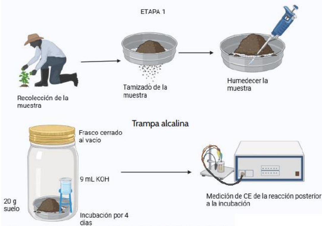
Figura 2. Procedimiento de preparación del suelo e incubación mediante trampa alcalina para evaluar la respiración de suelo. Método (Batterman, et al. , 2022). Diagrama elaborado por Alejandra Valles
