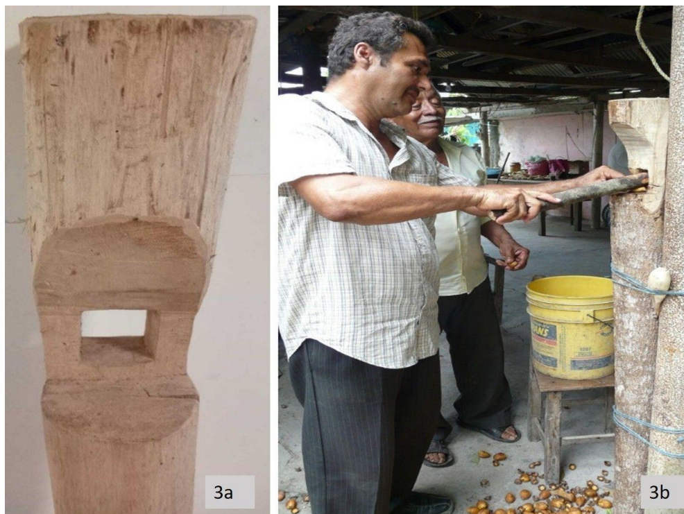
Figura 3a. Vista frontal del palo pela corozo. 3b. uso del palo pela corozo y complemento para eliminar la cáscara del fruto. Figure 3a. Front view of the palo pela corozo. 3b. use of the palo pela corozo and accessory for removing the fruit's peel.
